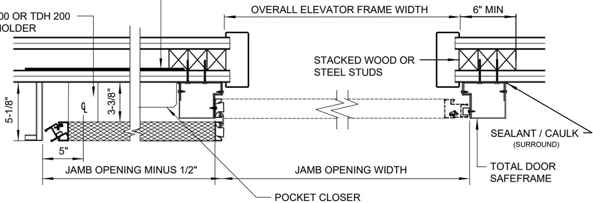
JUNCTION BOX ONLY REQUIRED FOR TDH200 MAG LOCATED 5" FROM END OF POCKET AND 2-1/2" DOWN FROM TOP OF DOOR
